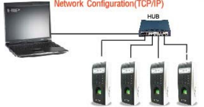
ต่อเป็น Network โดยใช้ TCP/IP สามารถต่อเข้ากับระบบ Network พื้นฐานได้ โดยการกำหนด IP Address ให้กับเครื่อง F 707
